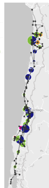
Figura 54. Expansión de activos de transmisión en el Escenario Exploratorio Favorable (E3) para la época de largo plazo (2043-2057). Para una mejor presentación de los resultados, estos son filtrados para una capacidad de expansión acumulada mínima de 100 MVA. Activos de transmisión ordenados de Norte a Sur en sentido izquierda a derecha. Mapa con la expansión de la época y la red representativa de 234 nodos.
