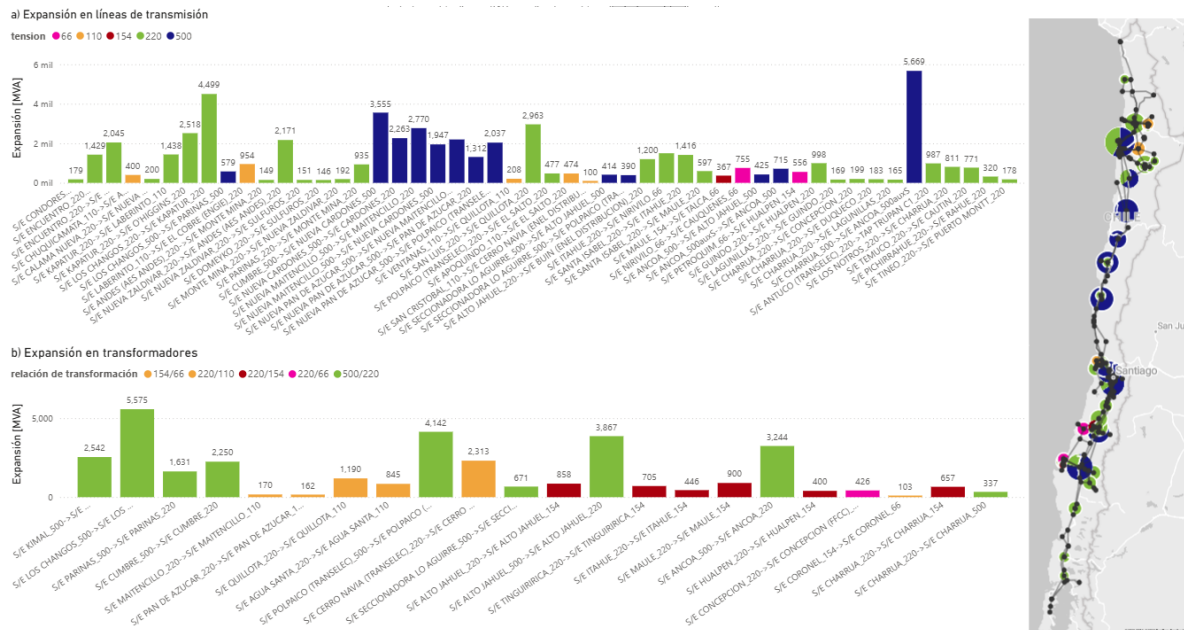
Figura 63. Expansión de activos de transmisión en el Escenario Normativo Desfavorable Mitigado (N1) para la época de largo plazo (2043-2057). Para una mejor presentación de los resultados, estos son filtrados para una capacidad de expansión acumulada mínima de 100 MVA. Activos de transmisión ordenados de Norte a Sur en sentido izquierdo a derecha. Mapa con la expansión de la época y la red representativa de 234 nodos.
